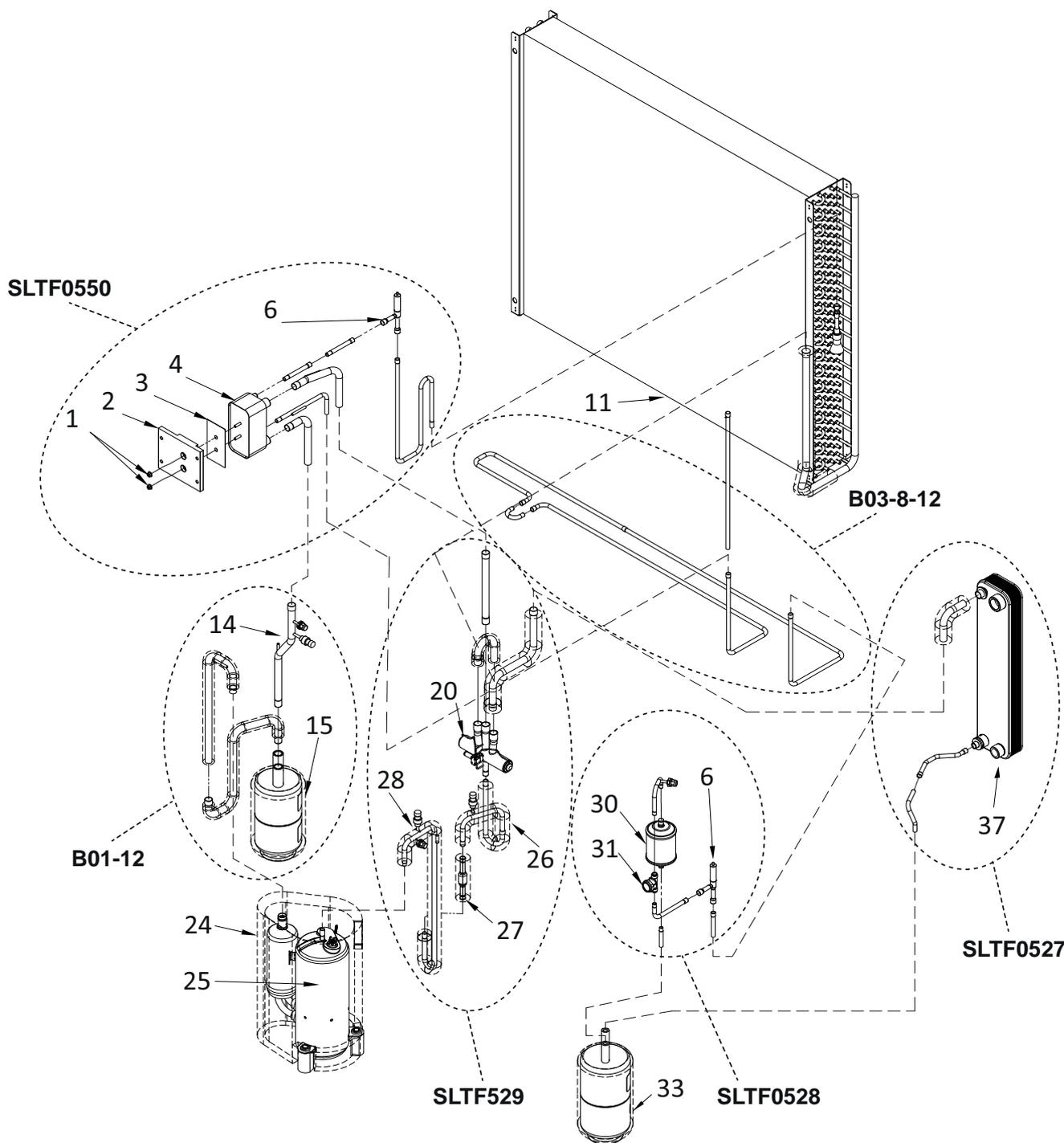
**Pompa di calore RE-PCM TH 9 - 12 - 14 kW - Circuito frigo con collegamenti**
